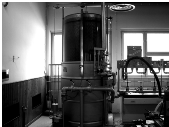
Fig.1. The bell prover RKA 1000 (Rombach)
