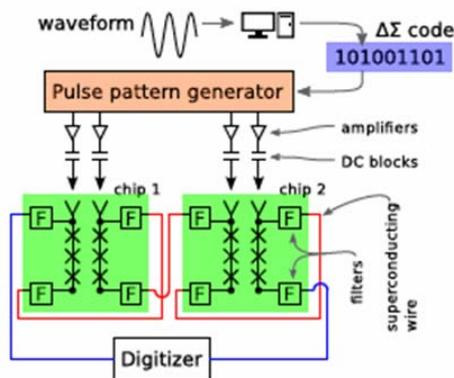
Fig.1. Schematic of JAWS system at Physikalisch-Technische Bundesanstalt (PTB)
